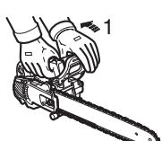
1. Position der Kettenbremse: Gelöst
