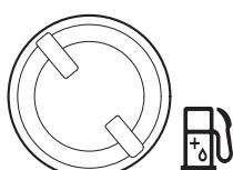
Tappo del serbatoio del lubrificante per catene
