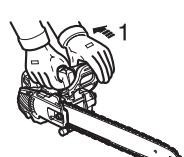
♦ Apriete gradualmente el gatillo del acelerador para aumentar las revoluciones del motor.
