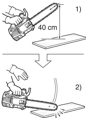
El freno de cadena no manual detiene el funcionamiento de la cadena de la sierra de tal modo que la acción de retroceso provocada por el extremo de la barra guía activa de forma no manual el freno de cadena.
