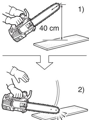
Il freno catena automatico è concepito in modo tale che il contraccolpo prodotto sull'estremità della barra guida attivi automaticamente l'azione frenante.
