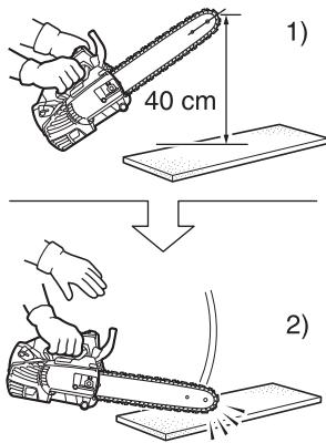
Die automatische Kettenbremse stoppt den Betrieb der Motorsäge derart, dass die am Ende der Kettenschiene erzeugte Rückschlagwirkung automatisch die Kettenbremse betätigkt. Gehen Sie auf folgende Weise vor, um sicherzustellen, dass die automatische Kettenbremse richtig funktioniert:
