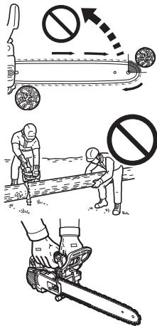
Eine Motorsäge darf immer nur von einer Person bedient werden.
